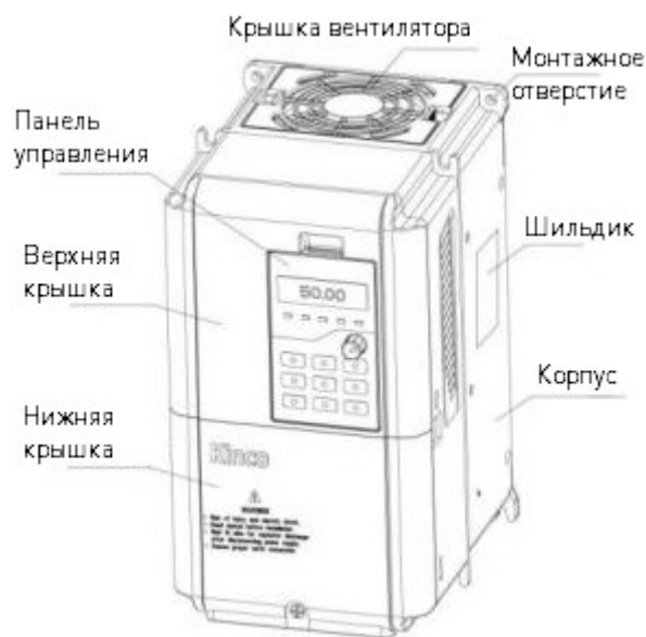
Рисунок 1 – Преобразователь частоты FV20 мощностью \leq 18.5 кВт.
