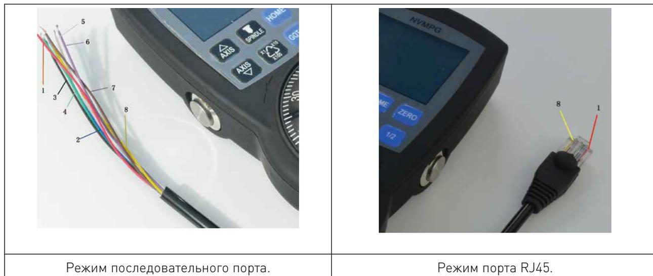
Рисунок 2 – Подключение пульта NVMPG.
