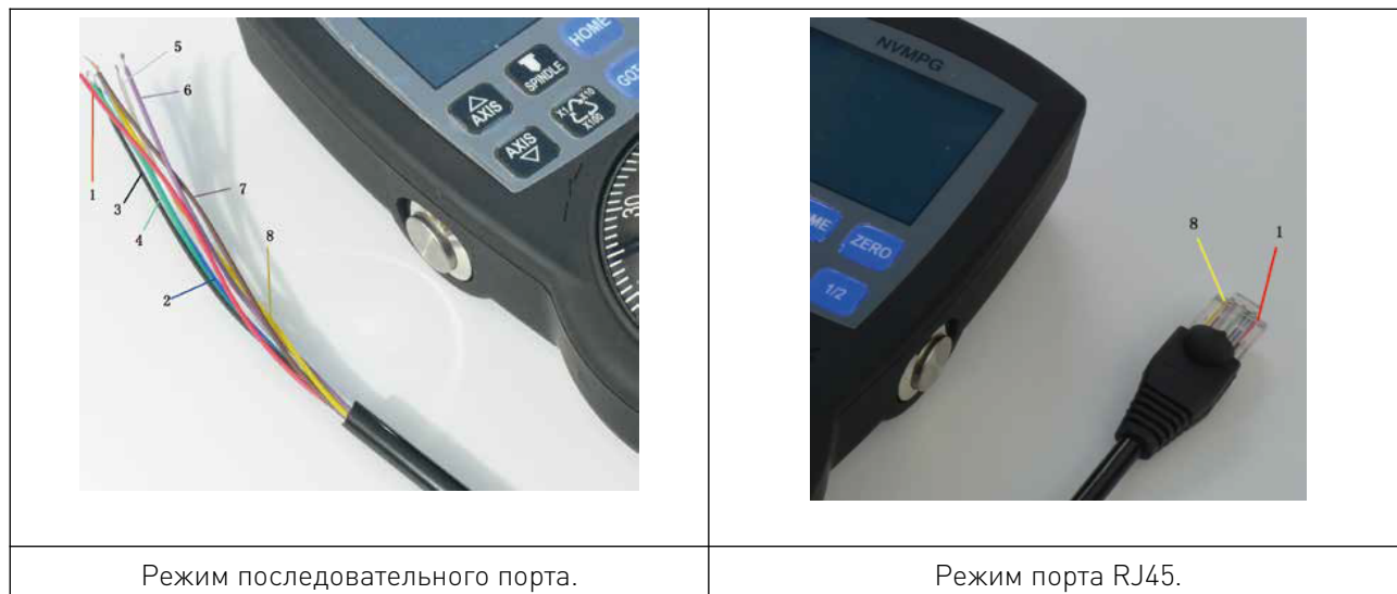
Рисунок 2 – Подключение пульта NVMPG.
