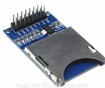
**Модуль SD карты ARD3001** предназначен для записи, хранения и считывания данных на SD карту. Файловая система SD карты может быть FAT16 или FAT32. Интегрированная в Arduino IDE библиотека SD.h позволяют наладить работу с пользовательскими файлами и директориями. Легко подключается как периферийное устройство к различным платам Arduino. SD карт ридер работает по SPI протоколу.
