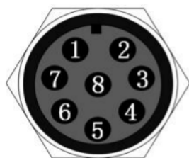
Рисунок 17 – Разъем для подключения кабеля PWE.
