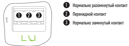
Рис. 15. Распиновка разъёма реле (поз. 10, 12 рис. 3).
