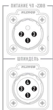
Рис. 4. Распиновка разъёмов питания и шпинделя (поз. 1, 2 рис. 3).
