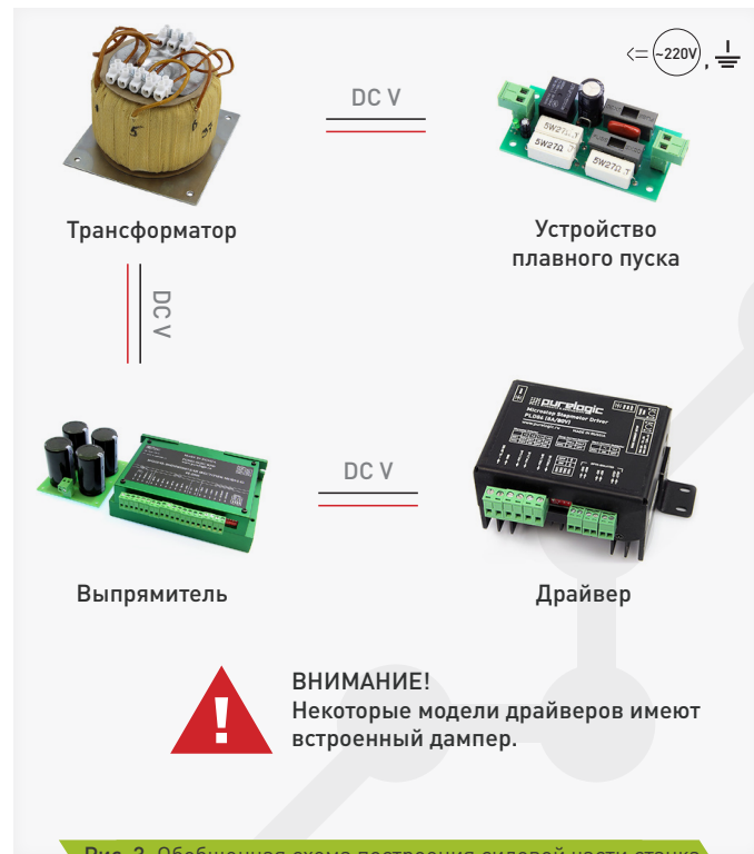
Рис. 3. Обобщенная схема построения силовой части станка
