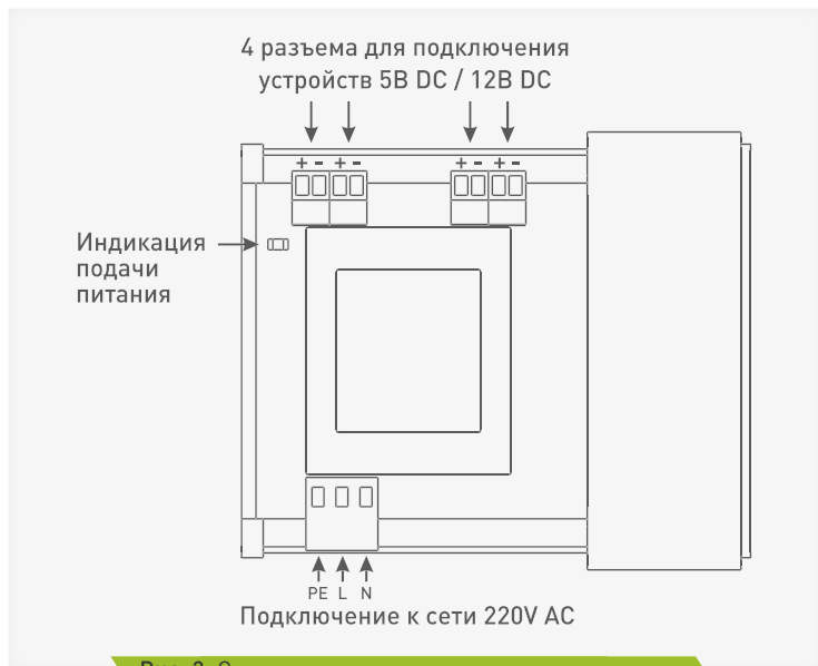
Рис. 2. Схема подключения и назначение выводов
