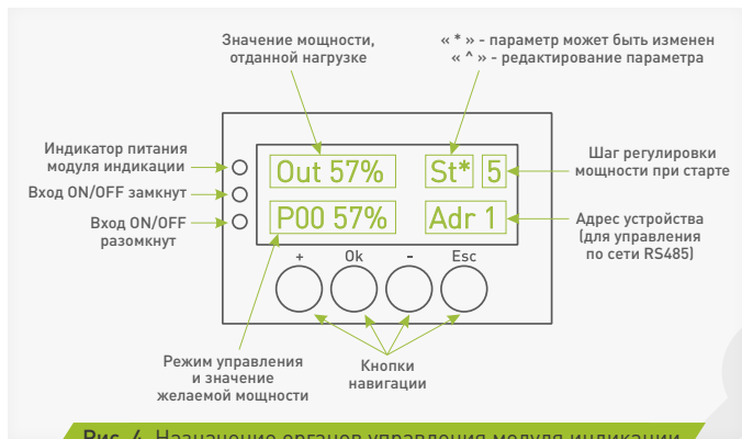
Рис. 4. Назначение органов управления модуля индикации
