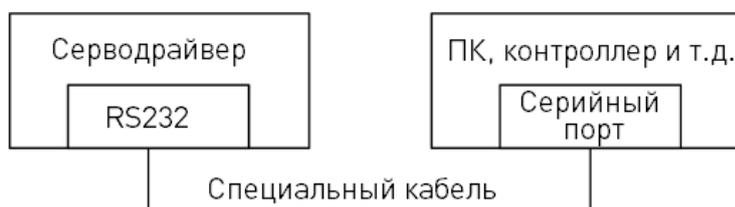
Рисунок 22 – Принципиальная схема подключения через RS232.
