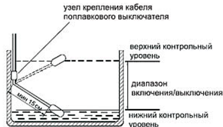
Рис. 4. Крепление кабеля выключателя после погружения в резервуар
