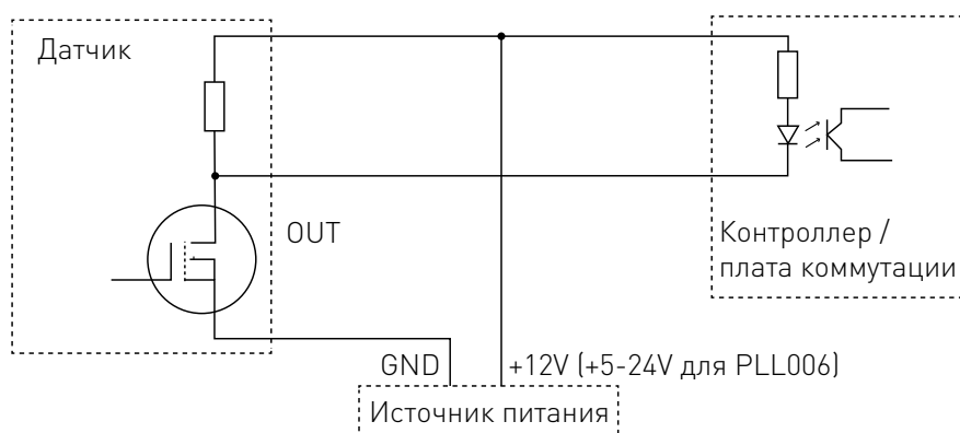
Рисунок 11 — Подключение датчика к устройствам с опторазвязкой. Вариант 2.
