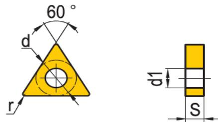
Рисунок 5 – Пластина в форме треугольника TNxxxx.
