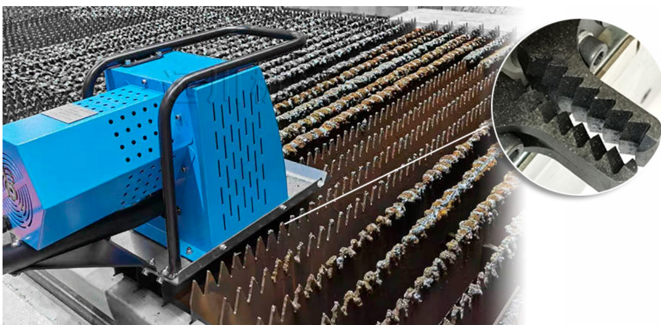
Рисунок 2 — Перемещение аппарата вдоль ламелей.
