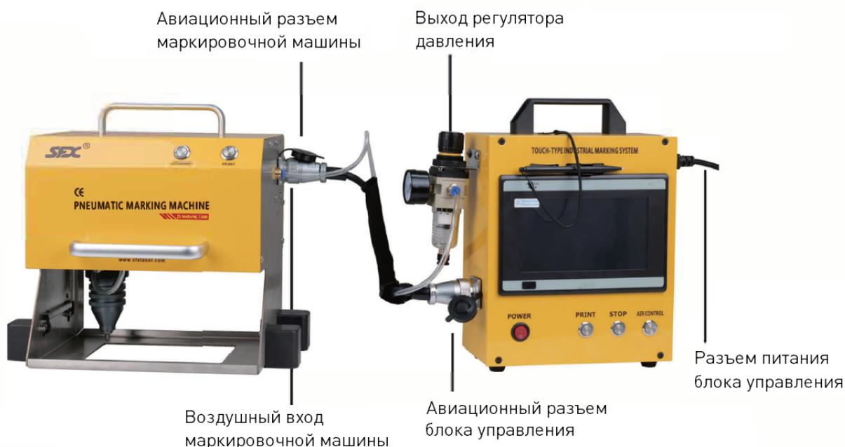
Рисунок 3 – Схема собранной пневматической маркировочной машины.
