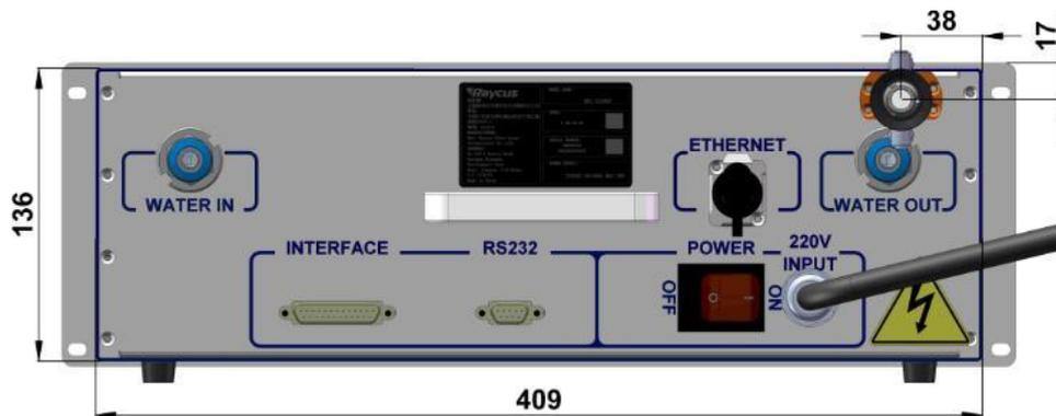
Рисунок 2 – Вид сзади источников RFL-C1000, RFL-C1500 (мм).
