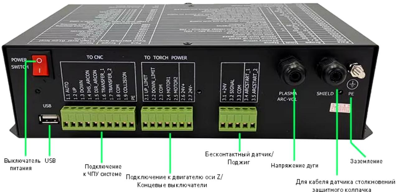
Рисунок 8 – Задняя панель контроллера THC F1621.
