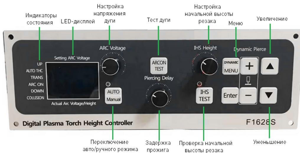
Рисунок 13 – Панель оператора F1628S (расположение элементов панели оператора контроллера F1628D, а также передней панели контроллера F1629DV аналогично).
