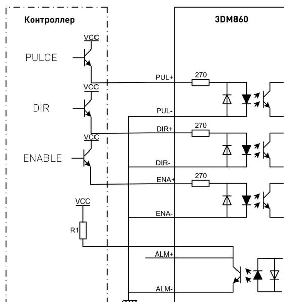
Рисунок 10 — Типовая схема подключения драйверов 3DM с общим катодом.
