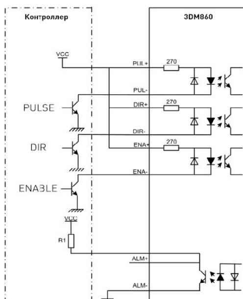
Рисунок 9 — Типовая схема подключения драйверов 3DM с общим анодом.
