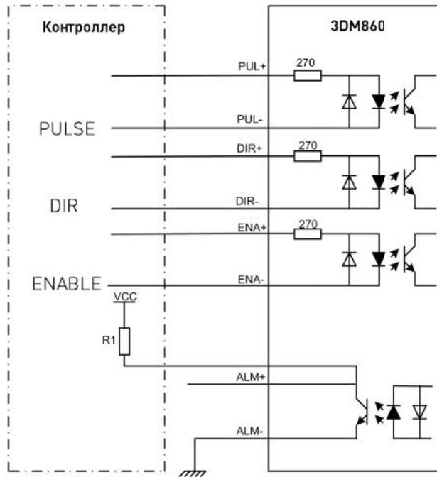
Рисунок 11 — Типовая схема подключения драйверов 3DM с дифференцированным сигналом.
