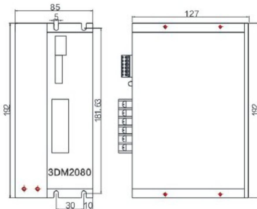
Рисунок 3 — Габаритный чертеж драйвера 3DM2080.
