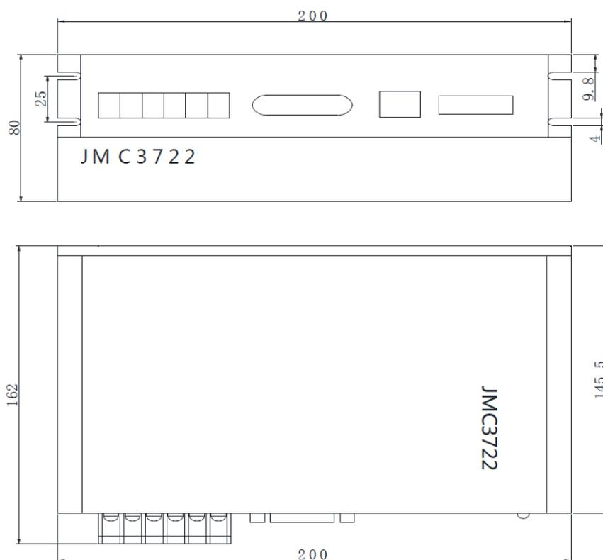
Рисунок 4 — Габаритный чертеж драйвера 3DM3722.
