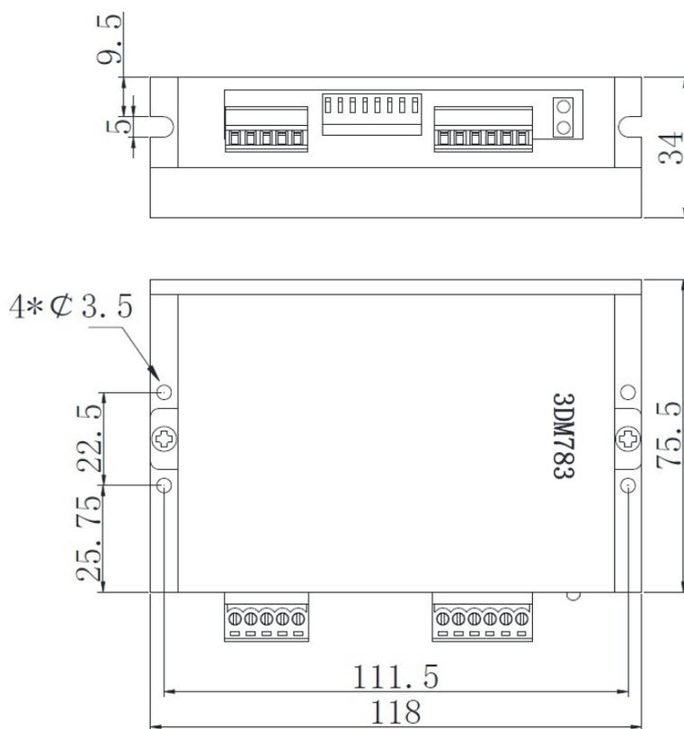
Рисунок 1 — Габаритный чертеж драйвера 3DM783.
