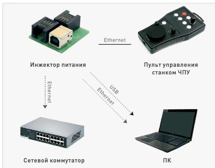
Рис. 3. Схема подключения инжектора питания
