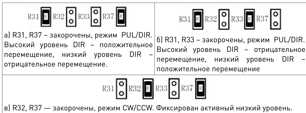
Рис. 3. Настройка протоколов PUL/DIR и CW/CCW
