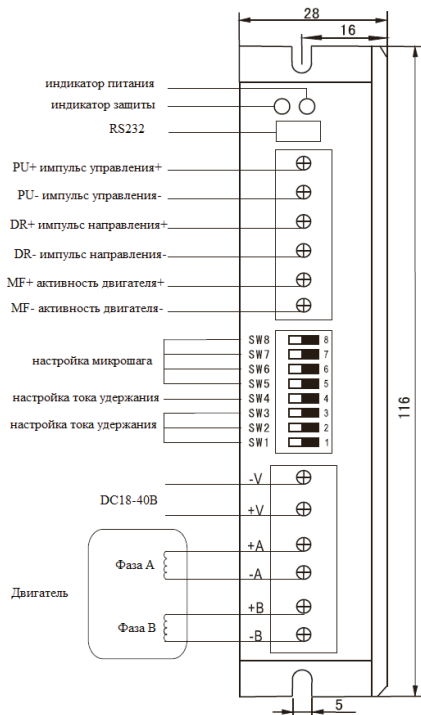
Рис. 2. Подключение драйвера
