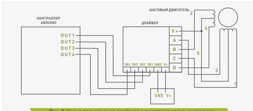
Рис. 3. Схема подключения драйвера к двигателю через контроллер
