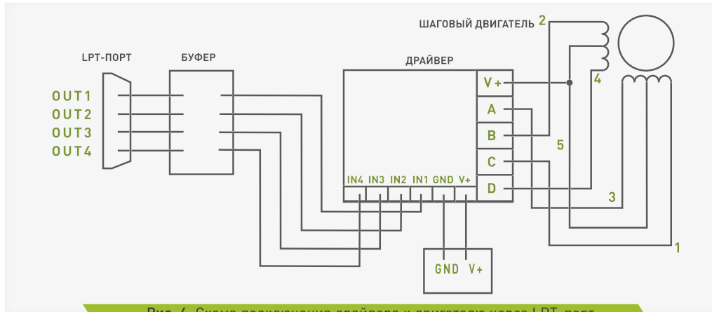
Рис. 4. Схема подключения драйвера к двигателю через LPT-порт
