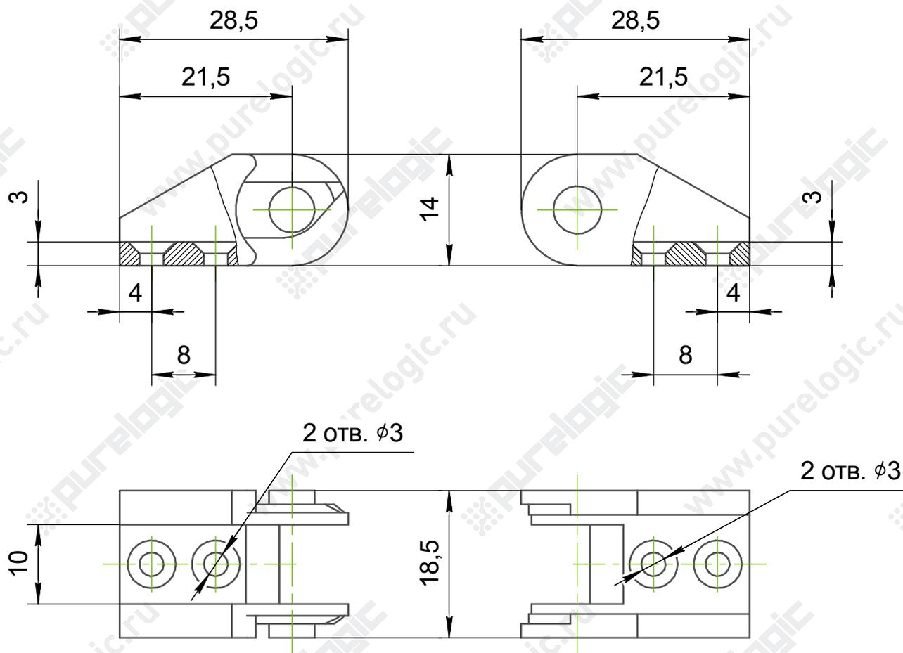
Держатель пластикового кабель-канала ТРН 10x15/10x20
