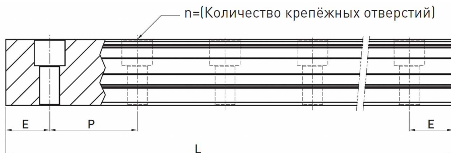
Рис. 14. Стандартная и максимальная длина рельса
