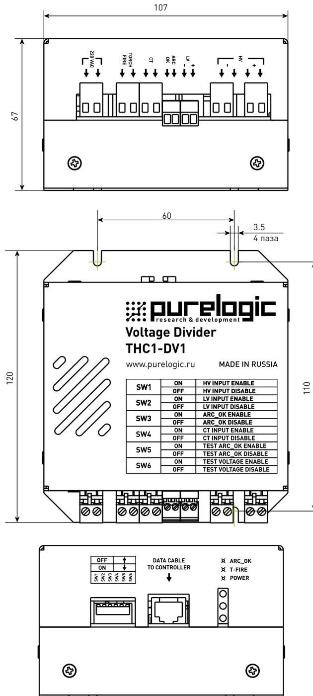
Рисунок 31 — Габаритные и установочные размеры модуля сопряжения THC1-DV1.
