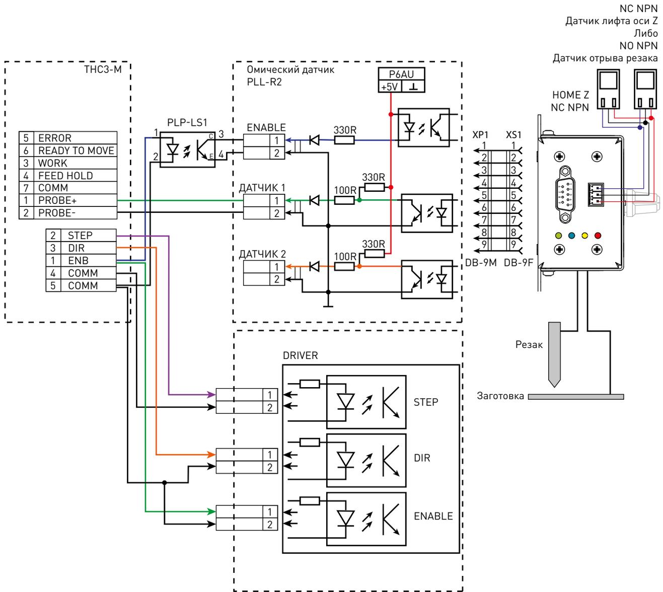
Рисунок 15 — Схема подключения контроллера к омическому датчику.
