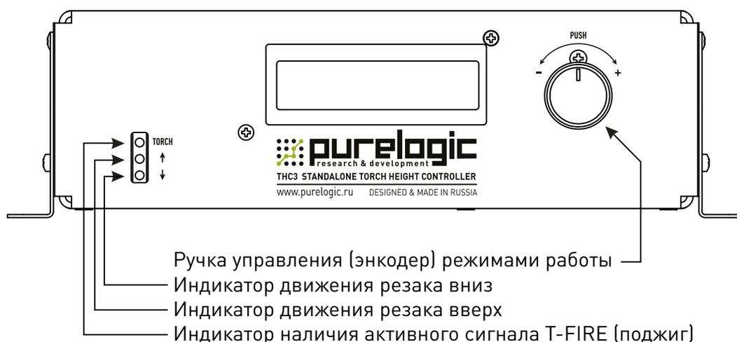
Рисунок 3 — Вид спереди модуля управления THC3-M.
