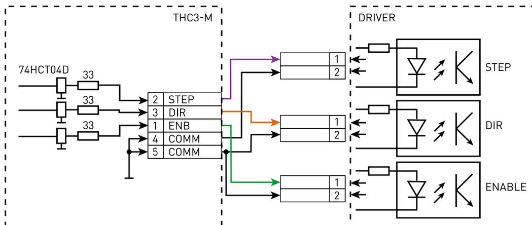
Рисунок 12 — Схема подключения драйвера оси Z.
