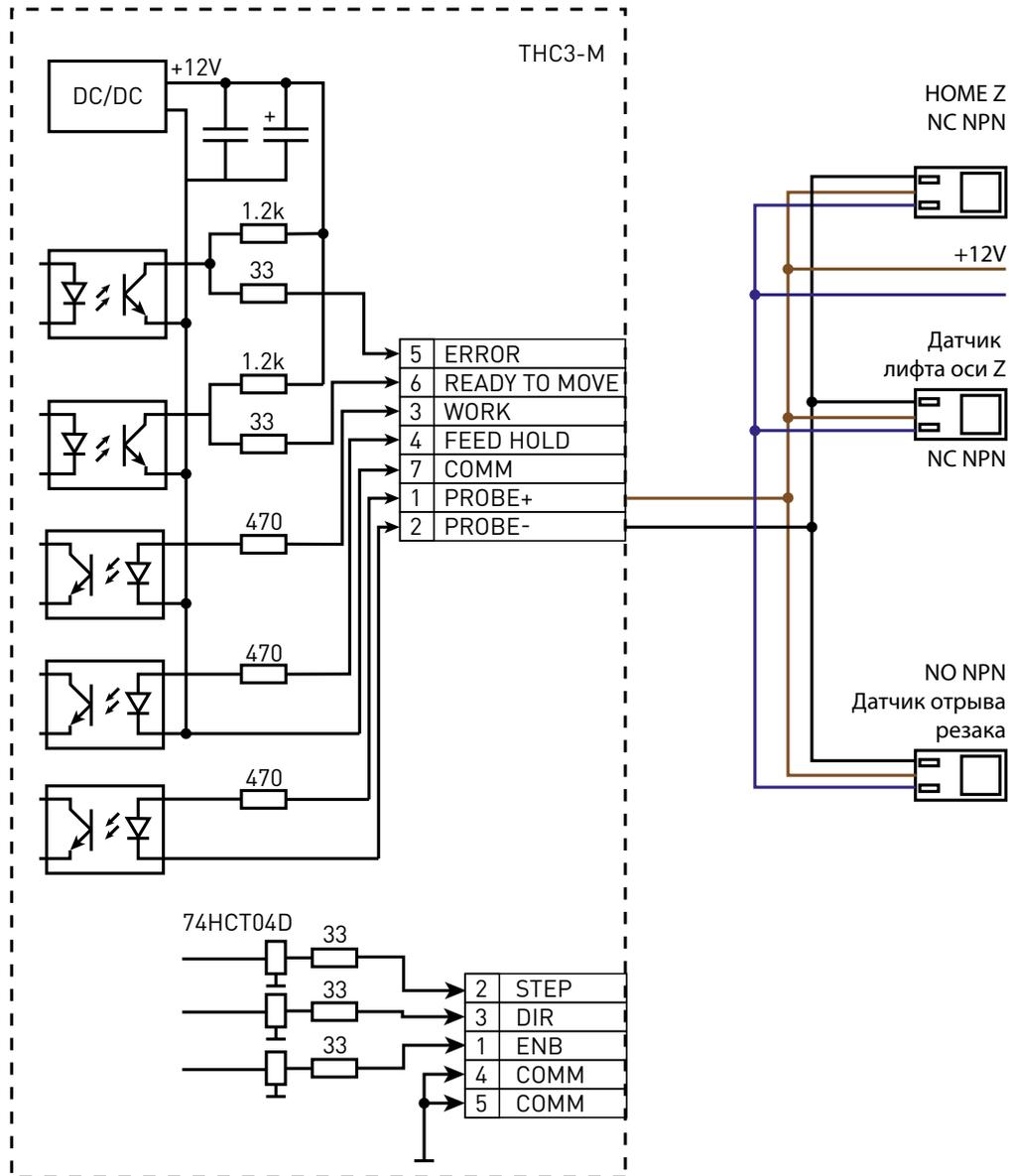
Рисунок 16 — Схема подключения контроллера к датчикам подъемника резака.
