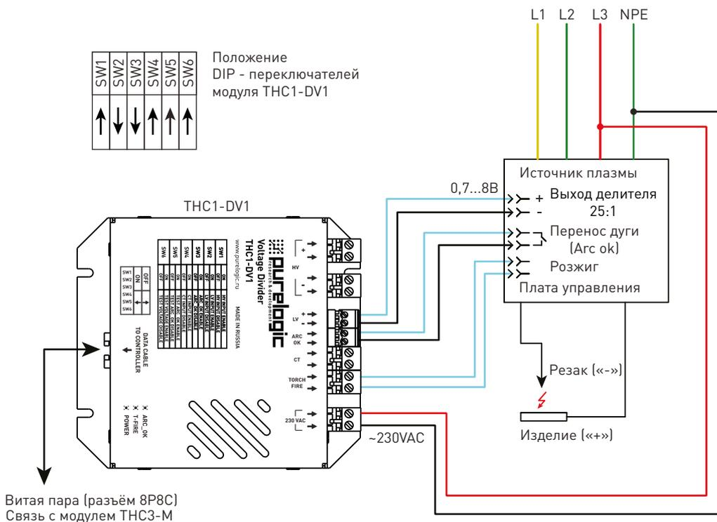
Рисунок 9 — Подключение модулей к источнику, оборудованному делителем напряжения.
