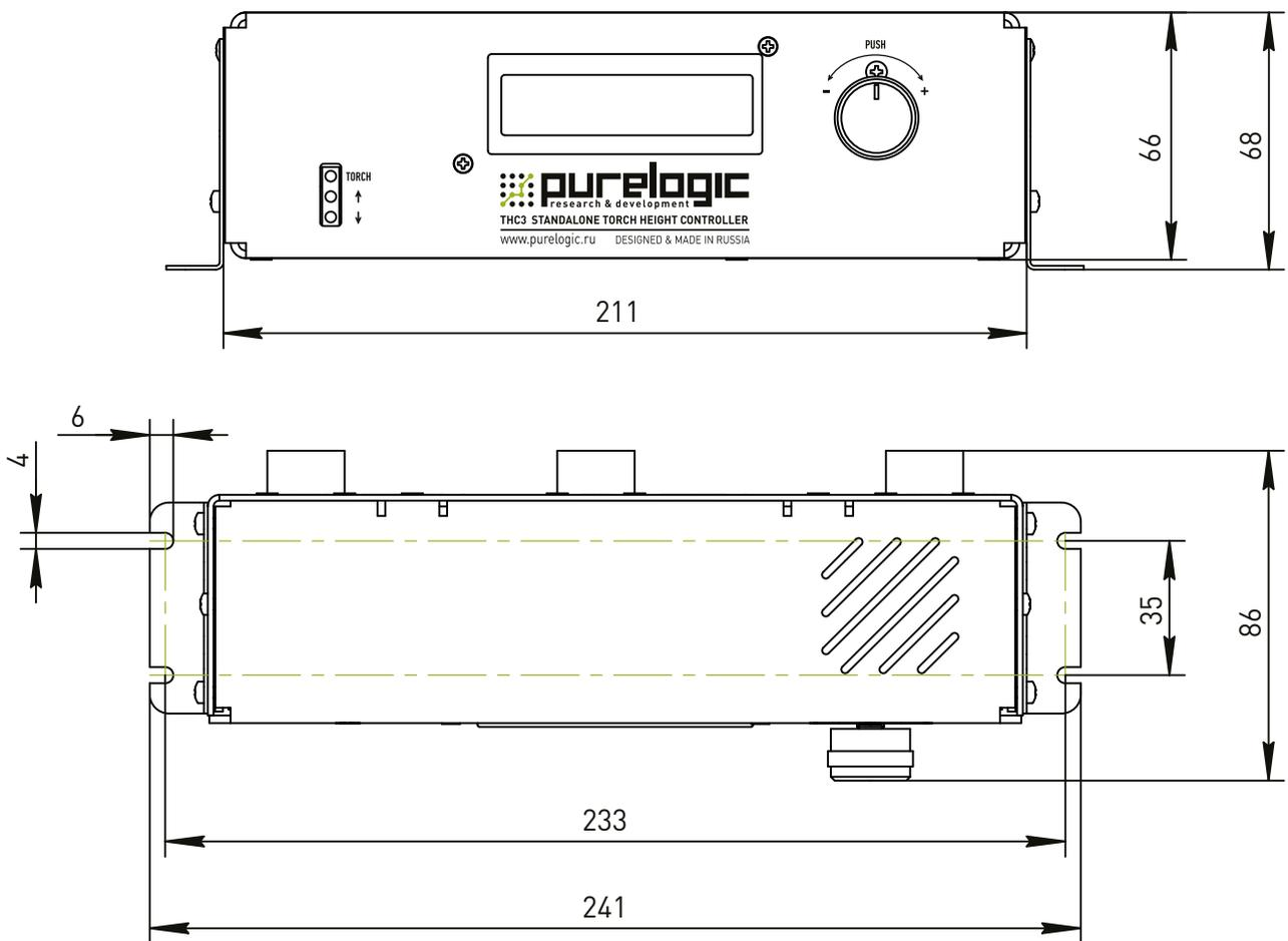
Рисунок 29 — Габаритные и установочные размеры модуля управления THC3-M.
