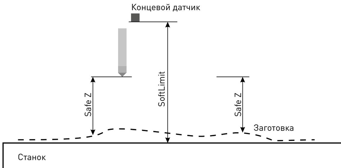
Рисунок 2 — Назначение параметров SAFE Z и SOFT LIMIT.
