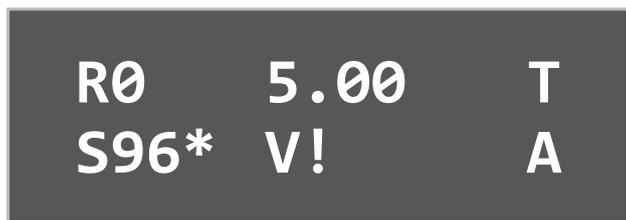
Рисунок 24 — Индикация при OVERVOLTAGE.
