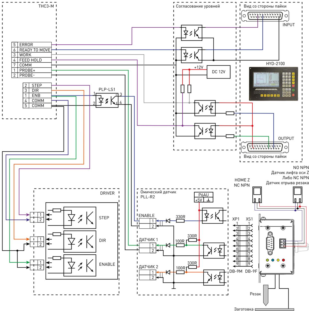
Рисунок 17 — Подключение к автономному контроллеру (на примере HYD-2100).
