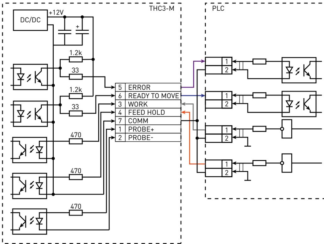
Рисунок 13 — Схема подключения контроллера к ПЛК с буферным выходом.
